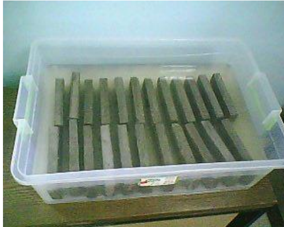
Şekil 4. Su emme ve kuruma deneyinde numunelerin bekletilme süreçleri
